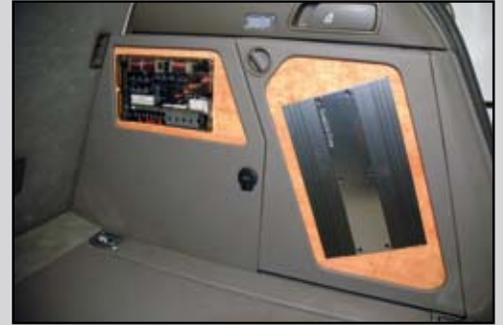
Pour ne pas encombrer le coffre avec un gros caisson de grave, la meilleure solution a été de réaliser un caisson sur-mesure dans un des deux flancs d'aile arrière. La place étant comptée dans le flanc gauche du caisson, Hifimobile a opté pour deux subwoofers Utopia de 13 cm. Ils donnent d'excellents résultats.
