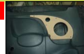
Le panneau est démonté et découpé. Il est renforcé avec un support en MDF pour loger le 165KRX2.
