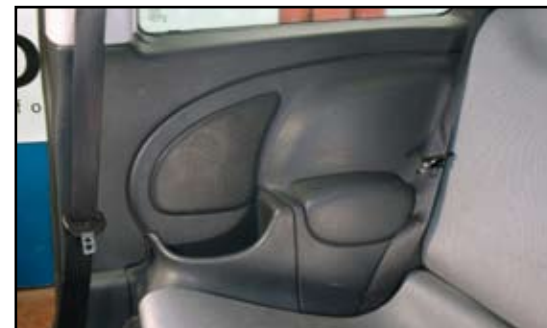
Les HP sont situés dans les flancs arrière. Emplacement petit, support pas assez rigide, un gros travail est nécessaire pour en tirer partie.
