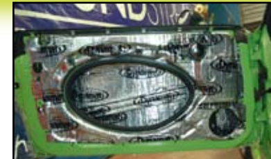
Les portes sont entièrement insonorisées au Dynamat. Ça paraît simple comme ça, mais pour le faire aussi bien, cela prend beaucoup de temps.
