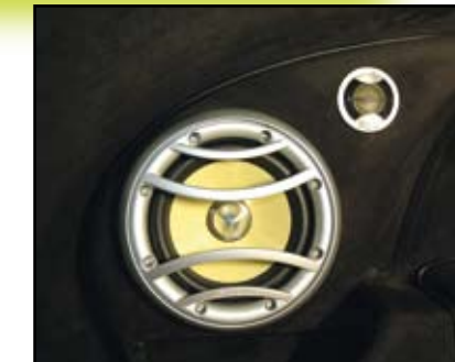
Comme pour les portes avant, le panneau est recouvert d'alcantara noir avant le montage du kit Focal. Les grilles ont également été repeintes : on a ainsi un montage efficace, discret tout en étant design !
