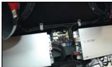
Les amplis sont fixés sur leur rack. Entre les deux, on peut voir le porte-fusible Raptor qui protège l'installation.
