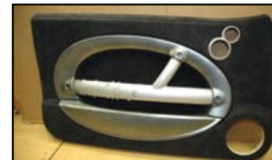
Après ponçage de la forme, le panneau de porte est habillé avec de l'alcantara noir.
