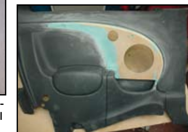
Ponçage et masticage permettent de redonner une forme harmonieuse au panneau de flanc arrière. Notons au passage que la modification est discrète et ne dénature pas le design de l'habitacle.
