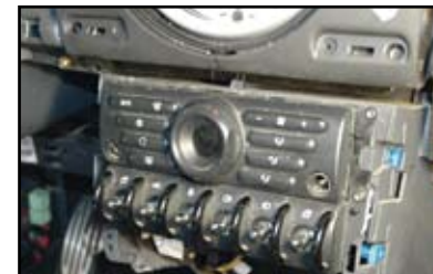
Les commandes de chauffage et la rampe d'interrupteurs sont remontés à la place de l'autoradio d'origine.
