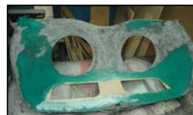
Le cache du caisson et le cache des amplis sont assemblés ensemble pour ne former qu'une seule pièce.
