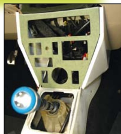
Pour intégrer le double Din et la voie centrale, des commandes d'origine de la voiture ont été déportés dans une nouvelle console centrale faite sur-mesure.
