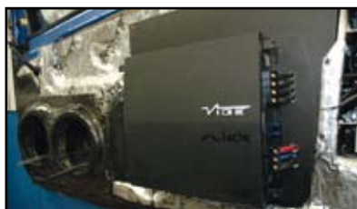
Après fibrage, les supports HP sont habillés en carbone véritable. La partie arrière de la porte accueille un ampli Vibe Slick sur un support en MDF.
