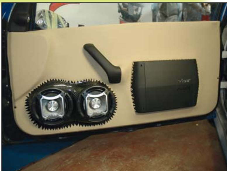
Une fois le travail fini, le support HP en carbone et l'ampli ressort à travers le cuir dentelé ; aussi beau qu'original !
