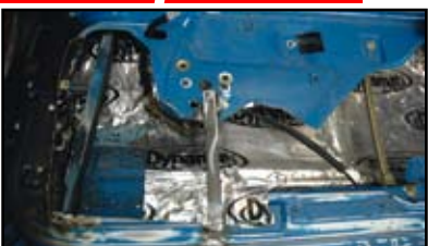
L'intérieur de la porte est bien sûr insonorisé. La structure de la contre-porte ayant été découpée, elle est renforcée par une patte en aluminium.
