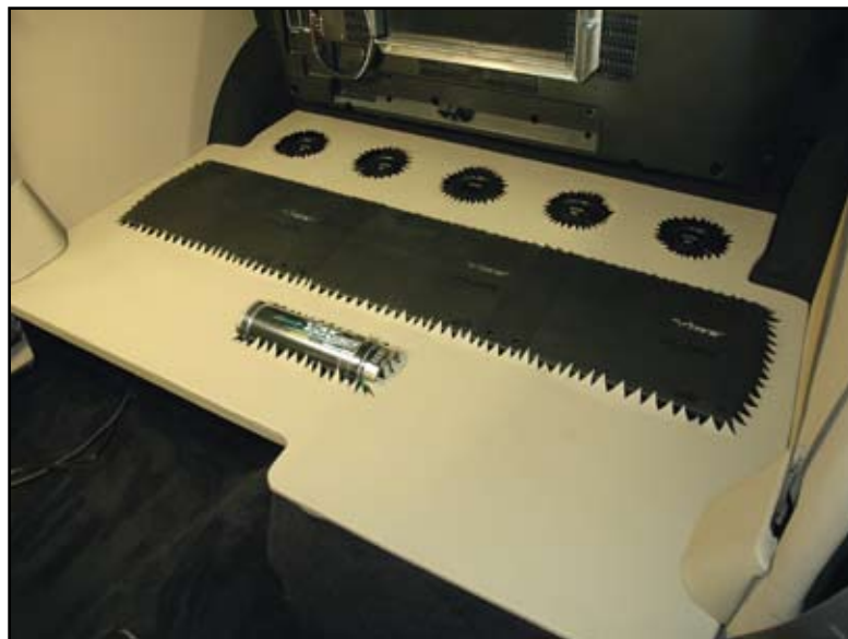
Un cache en moquette noire et cuir beige (réalisé sur une planche de MDF) dissimule l'installation pour ne laisser visible que le capot des amplis et des filtres passifs.
