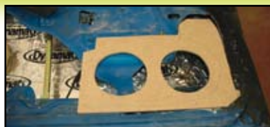
La découpe permet d'insérer un support en médium, qui va servir de base pour réaliser l'emplacement des deux woofers de 16,5 cm.
