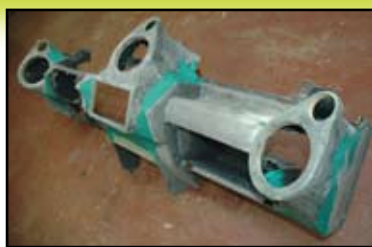
La nouvelle forme du tableau de bord est obtenue à partir de fibre et de résine. Au centre du tableau de bord, Hifimobile a réalisé un logement pour mettre un combiné double Din.
