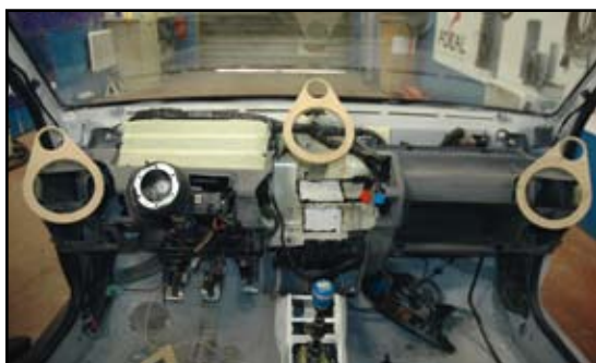
Le tableau de bord est démonté et découpé pour intégrer les voies médiums/aigus. Les supports HP sont réalisés en MDF.
