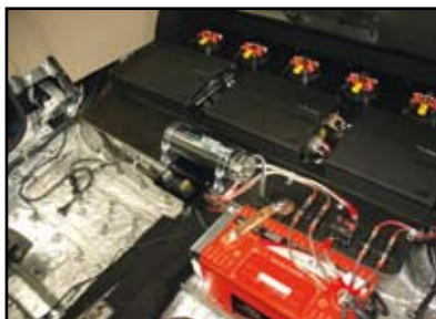
Les filtres et les amplis sont fixés sur le rack à la place de la banquette arrière. Devant, les amplis, on peut voir tout le système d'alimentation électrique de l'installation.
