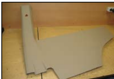
Avant d'être habillé de cuir beige, la garniture des flancs arrière est refaite en MDF et fibre.
