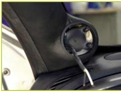
Voilà un des montants une fois remis en place, avec le support de tweeter fourni par Focal lui aussi installé dans son logement. Une fois de plus, ne pas oublier de passer le câble de branchement !
