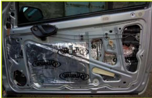
Le principe de départ est toujours le même : désossage de la contre-porte, puis traitement avec le matériau amortissant Dynamat, sur la plus grande surface possible.
