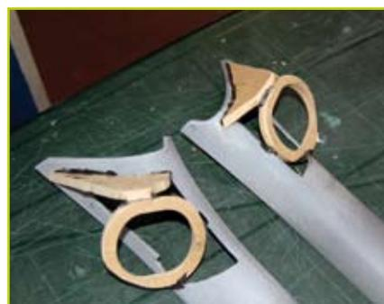
Les deux montants du pare-brise, en plastique, ont été démontés et soigneusement poncés. Julio construit ensuite un bâti pour diriger les tweeters, avec deux morceaux de bois maintenus en place par des plots de mastic.
