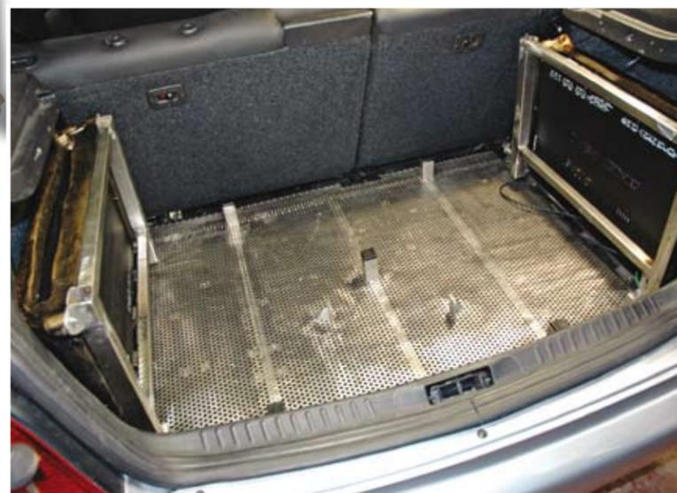
L'ensemble est maintenant mis en place dans le coffre de la Xsara. Notez les plots métalliques soudés sur la grille centrale. C'est aussi le moment de bien réfléchir à tous les problèmes annexes : passage des câbles, fixation parfaite de l'ensemble, refroidissement des amples...
