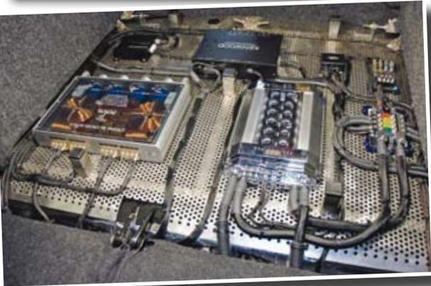
Outre le choix de câbles de très haute qualité, Julio a soigneusement calculé leur circuit. Notez l'utilisation intensive de gaine thermorétractable pour éviter tout court-circuit, ainsi que de colliers pour une fixation parfaite. Bien sûr, une protection sérieuse sur la ligne d'alimentation n'a pas été oubliée.
