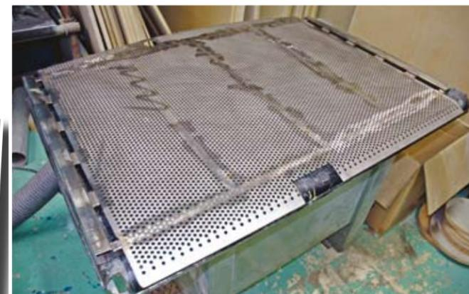
Une grille perforée est ensuite soudée directement sur le bâti. Elle recevra les différents éléments cachés dans le coffre...
