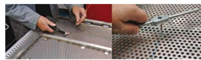
Cela sous-entend la soudure de pattes de fixation et le taraudage de filetages divers et variés. Julio da Silva prouve ainsi qu'il a plusieurs cordes à son arc, et qu'il est vraiment un surdoué de l'installation...
