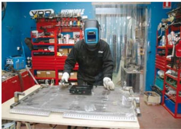
Tout commence avec ce bâti métallique, réalisé à partir de tubes à souder entre eux. Il prendra place dans le coffre de la Xsara.
