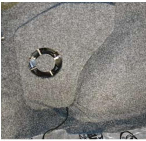
Le bon refroidissement est assuré par deux ventilateurs, camouflés sur des flancs de la garniture. C'est le genre de détail indispensable pour la fiabilité des plus belles installations.
