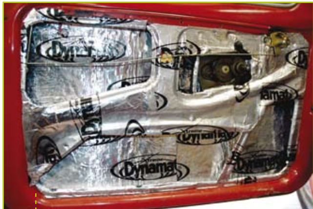
On voit ici l'entretoise découpée, en bas à droite. Tout l'intérieur de la portière est traité Dynamat, exactement comme le coffre.
