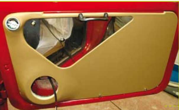
On voit ici l'entretoise découpée, en bas à droite. Tout l'intérieur de la portière est traité Dynamat, exactement comme le coffre.
