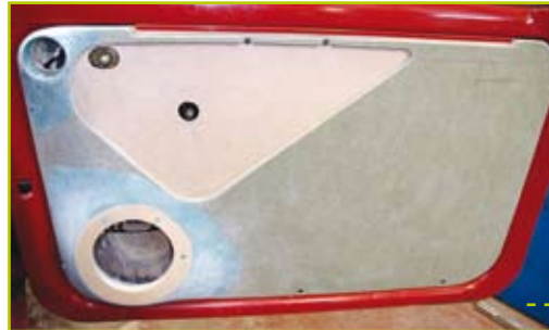
On voit ici l'entretoise découpée, en bas à droite. Tout l'intérieur de la portière est traité Dynamat, exactement comme le coffre.
