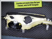
Place au traitement acoustique de la garniture au Dynaliner
