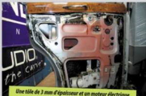
Une tôle de 3 mm d'épaisseur et un moteur électrique pour les vitres... déjà moderne!
