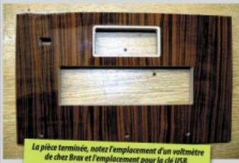
La pièce terminée, notez l'emplacement d'un voltmètre de chez Brax et l'emplacement pour la clé USB.
