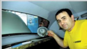
Reste à trouver les emplacements pour les woofers du 3 voies. Pour l'arrière, le mieux, c'est en plage donc démontage de celle-ci. Ô surprise, on y découvre un collecteur : un HP d'époque Goodmans !
