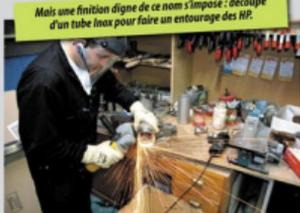
Mais une finition digne de ce nom s'impose: découpe d'un tube inox pour un entourage des HP.
