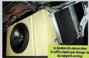
La fixation du caisson dans le coffre s'opère par vissage via les supports en inox.
