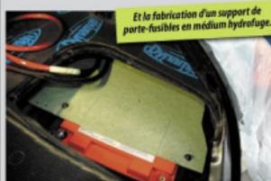
Et la fabrication d'un support de porte-fusibles en médium hydrofuge.
