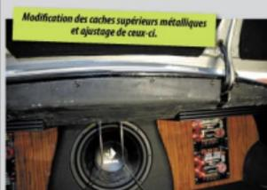
Modification des caches supérieurs métalliques et ajustage de ceux-ci.
