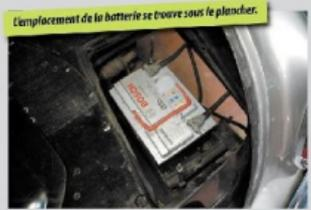
L'emplacement de la batterie se trouve sous le plancher.
