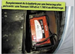
Remplacement de la batterie par une beaucoup plus puissante : une Tsunami 100 ah et 1700 A au démarrage.
