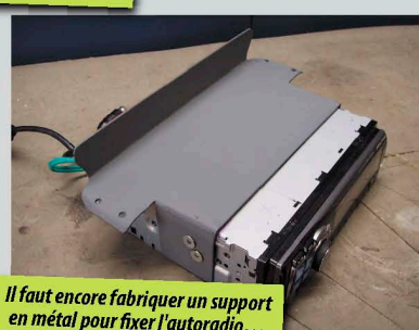
la platine est découpée pour la partie ventilation qui sera déplacée plus bas.
