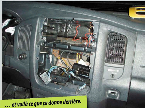
la platine est découpée pour la partie ventilation qui sera déplacée plus bas.
