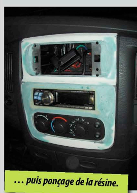
le ponçage de la console doit être minutieux avant peinture.
