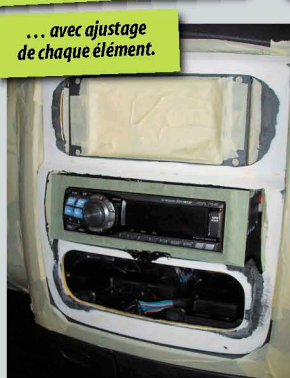
... puis collage du châssis plastique de l'écran sur la console !
