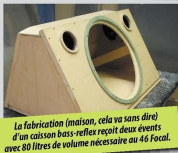
La fabrication (maison, cela va sans dire) d'un caisson bass-reflex reçoit deux événements avec 80 litres de volume nécessaire au 46 Focal.
