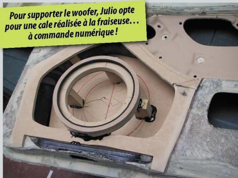
Pour supporter le woofer, Julio opte pour une cale réalisée à la fraiseuse... à commande numérique!
