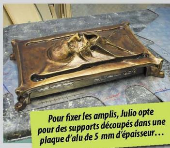
Pour fixer les amplis, Julio opte pour des supports découpés dans une plaque d'alu de 5 mm d'épaisseur...
