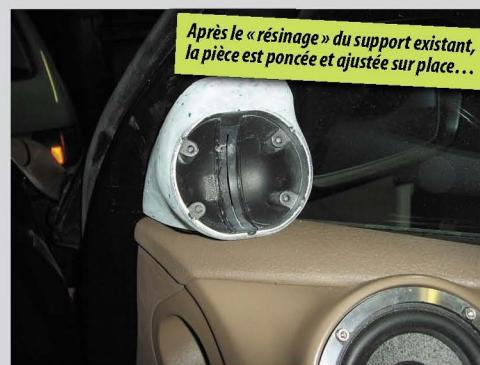
Après le « résinage » du support existant, la pièce est poncée et ajustée sur place...
