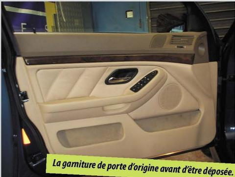
La garniture de porte d'origine avant d'être déposée.
