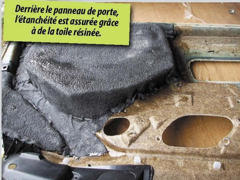
Derrière le panneau de porte, l'étanchéité est assurée grâce à de la toile résinée.
