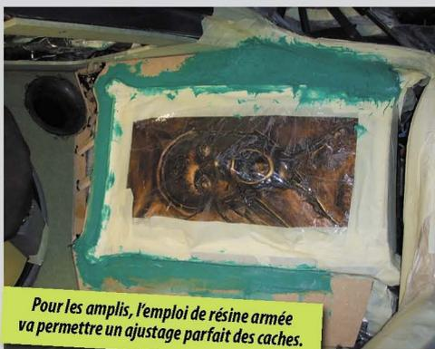
Pour les amplis, l'emploi de résine armée va permettre un ajustage parfait des caches.
