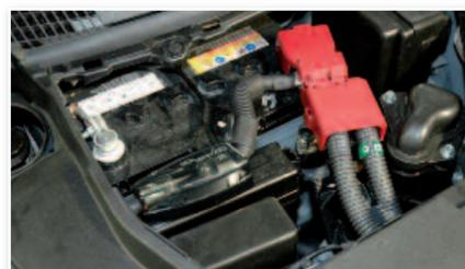
Mise en place d'un câble d'alimentation en 50 mm<sup>2</sup> ainsi que d'un porte-fusibles.
