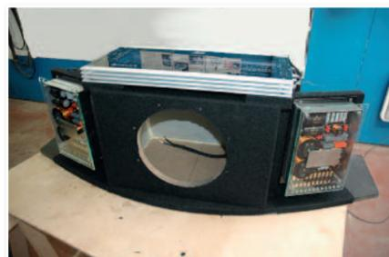
Garnissage du caisson et fixation de l'amplificateur et des superbes filtres passifs du kit Brax Matrix.
