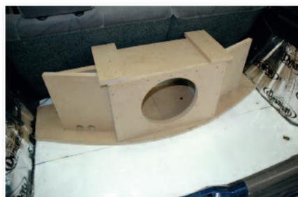
Ajustage du caisson dans le coffre avec les supports pour l'amplificateur et les filtres.
