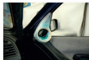
Ponçage du support et ajustage sur la porte.
