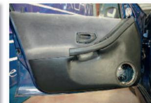
Assemblage des éléments du panneau avant fixation du panneau sur la porte.
