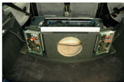
Fixation du caisson par vissage dans le coffre.
