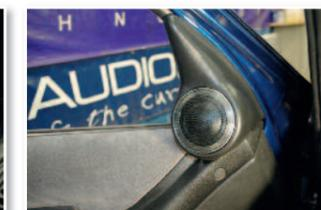
Mise en place du medium à dôme sur son support. Notez que ce genre de medium ne nécessite aucun volume car il est interne au châssis.
