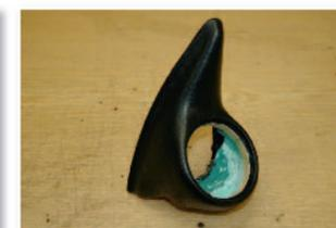
Masticage de finition des supports avant garnissage des supports en simili.
