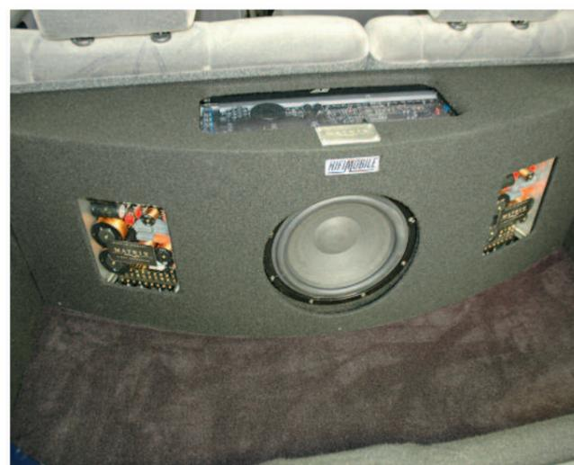
Mise en place du cache garni sur le caisson.
