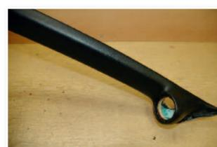
Ponçage de finition des montants puis garnissage des montants en simili.
