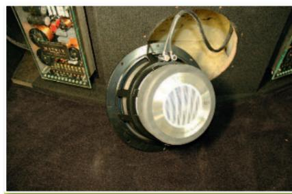
Câblage et fixation du subwoofer Brax Matrix.
