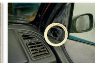
Mise en place des supports sur les caches de rétroviseur.
