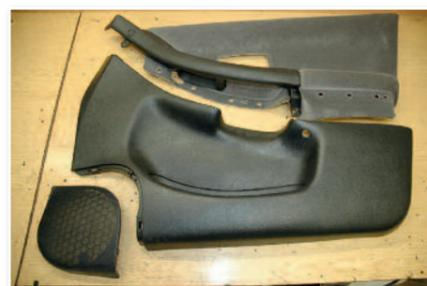
Désassemblage des éléments du panneau de porte.
