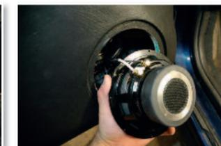
Câblage et fixation des woofers.
