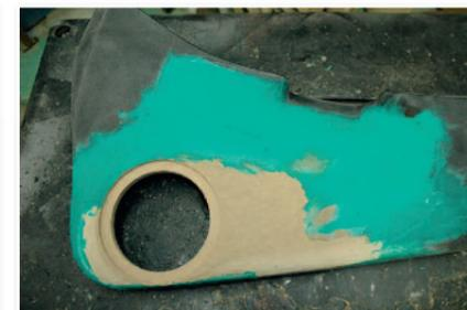
Fixation de la plaque et ajustage au mastic fibre sur le panneau.
