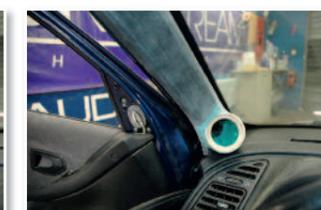
Résinage des montants avant ponçage et ajustage des montants à leur emplacement.
