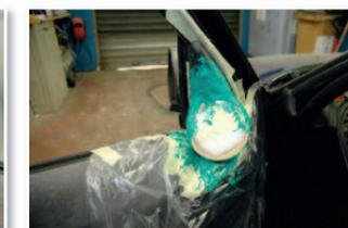
Résinage des supports sur le cache de rétro.
