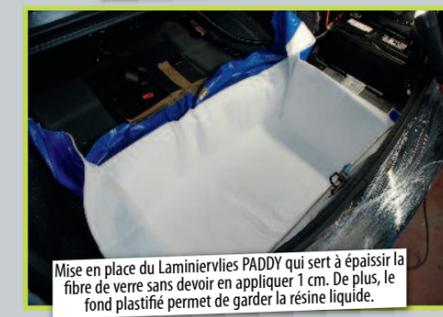
Mise en place du Laminier PADDY qui sert à épaissir la fibre de verre sans devoir en appliquer 1 cm. De plus, le fond plastifié permet de garder la résine liquide.
