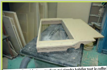
Fabrication d'un châssis en medium qui viendra habiller tout le coffre et qui servira à la fixation des supports d'amplificateurs.
