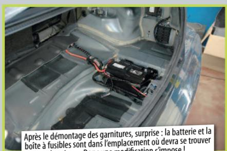
Après le démontage des garnitures, surprise : la batterie et la boîte à fusibles sont dans l'emplacement où devra se trouver le caisson. Donc une modification s'impose !
