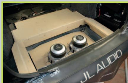
Mise en place du châssis dans le coffre.
