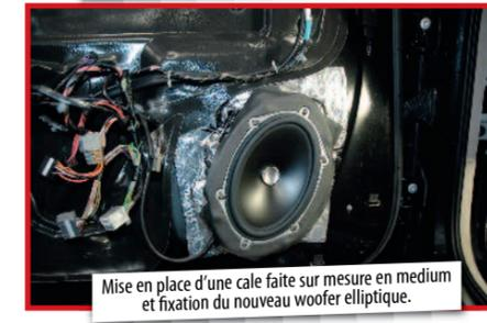
Mise en place d'une cale faite sur mesure en medium et fixation du nouveau woofer elliptique.
