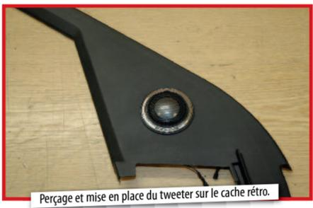
Perçage et mise en place du tweeter sur le cache rétro.
