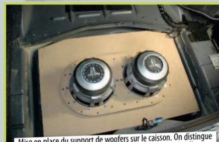
Mise en place du support de woofers sur le caisson. On distingue bien l'utilité de ce support car les subwoofers sont fixés à l'envers, ce qui permet de les monter dans une faible profondeur (ce qui aurait été impossible à l'endroit).
