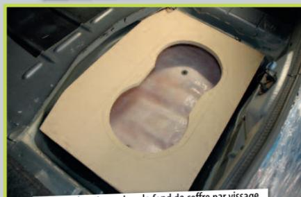
Fixation du caisson dans le fond de coffre par vissage.
