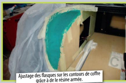
Ajustage des flasques sur les contours de coffre grâce à de la résine armée.
