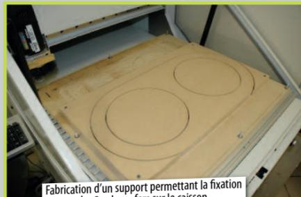
Fabrication d'un support permettant la fixation des 2 subwoofers sur le caisson.
