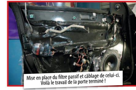
Mise en place du filtre passif et câblage de celui-ci. Voilà le travail de la porte terminé !
